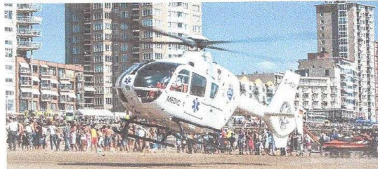
De EC135 heeft een kenmerkende staart, waarbij de rotoren ingekapseld zitten. (Foto Tom)
